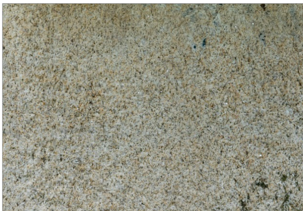
Obr. 2-8: Jemně zrnitá dvojslídňá žula, pravděpodobně z lomu mezi Broumovem a Chodským újezdem. Podstavec pomníku sv. Jana Nepomuckého v Kyjově. / Feinkörniger Zweiglimmergranit, vermutlich aus dem Steinbruch zwischen Broumov und Chodský Újezd. Sockel des Johannes-Nepomuk-Denkmal in Kyjov (Khoau).
