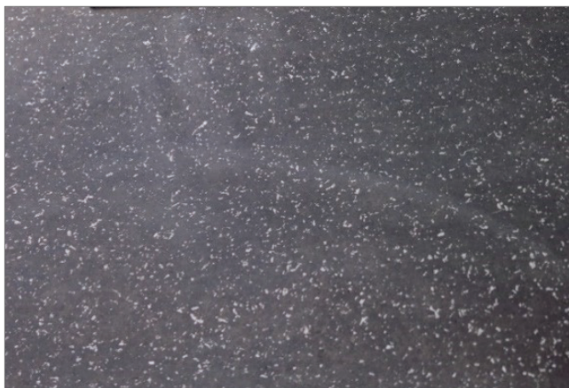
Obr. 2-18: Na vysoce leštěných plochách černého švédského doleritu lze v protisvětle rozeznat světle šedá kovově lesklá zrna magnetitu. Náhrobek rodiny MÖCHELOVY, nový hřbitov v Plané. / Auf den hochglänzend polierten Oberflächen des Schwarz-Schwedisch-Dolerits erkennt man im Gegenlicht die hellgrau-metallisch glänzenden Magnetitkörnern. Grabmal MÖCHEL, Neuer Friedhof Planá.
