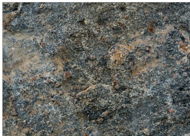
Obr. 2-11: Granátický amfibolit z mariánskolázeňského komplexu na území města Planá. Kámen je použit ve velké zdi z lomového kamene v ulici Na Příkopech. Šířka zobrazení cca 20 cm. / Granatamfibolit aus dem Marienbader Komplex im Stadtgebiet von Plana. Der Stein ist in der großen Bruchsteinmauer an der Na Příkopech-Straße verbaut. Bildbreite: ca. 20 cm.
