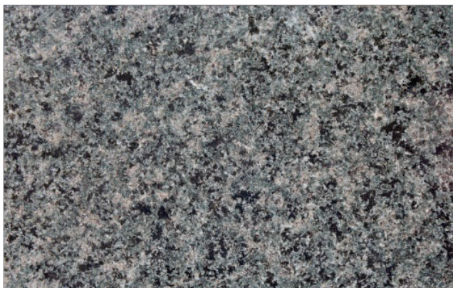
Obr. 2-16: Gabro s bílými krystaly živce, zelenavými amfiboly a pyroxeny a drobnými zrny granátu je na počátku 20. století „módním“ pomníkovým kamenem v Plané. Památník městských lesů v Plané, firma JOSEF LUGNER. / Der Gabbro mit weißen Feldspatleisten, grünlichen Amphibolen und Pyroxenen sowie kleinen Granaten ist im frühen 20. Jh. ein „modisches“ Denkmalgestein in Planá. Stadtwald-Denkmal, F. J. LUGNER.
