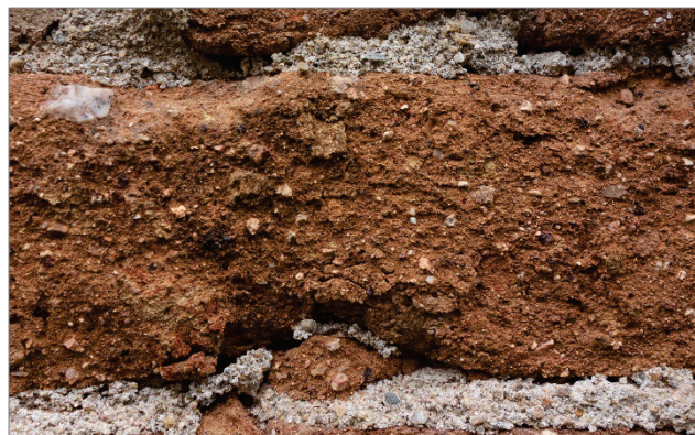
Obr. 2-9: Ručně vyrobená cihla s ostrými zrny křemene a úlomky horniny, event. přímo z jílových usazenin v třetihorní sníženině západně od Plané. Šířka zobrazení cca 15 cm. / Handgeschlagener Ziegel mit eckigen Magerungskörnern aus Quarz und Gesteinsbruchstücken, evtl. direkt aus den Lehmvorkommen in der tertiären Senke westlich von Planá. Bildbreite ca. 15 cm.
