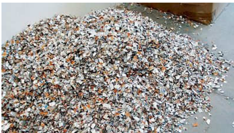
Kartony se rozdrtí, vyperou, usuší a pak se při teplotách okolo 200 °C lisují do desek.
